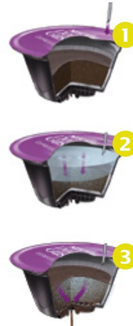
1 Al insertar una cápsula, una pequeña aguja la penetra en su parte superior y permite el ingreso del agua a un alto nivel de presión.
